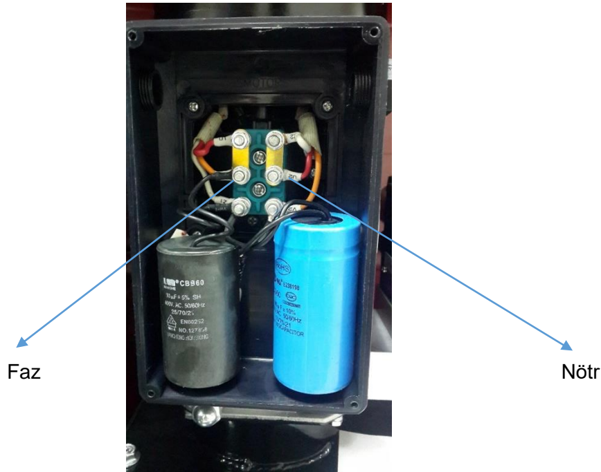
Resim 5. 220 V AC tek fazlı motorlarda bağlantı*
